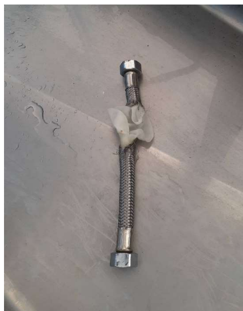
破損したホース
