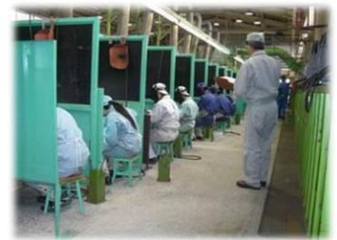
①「被覆アーク溶接」とは、母材と同じ材質の金属棒を心線(電極)として、心線と母材との間にアークを発生させ、それを熱源として溶接する方法。
