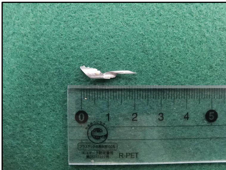
[令和5年6月29日（木）混入した金属片（押し板から剥離したもの）]
