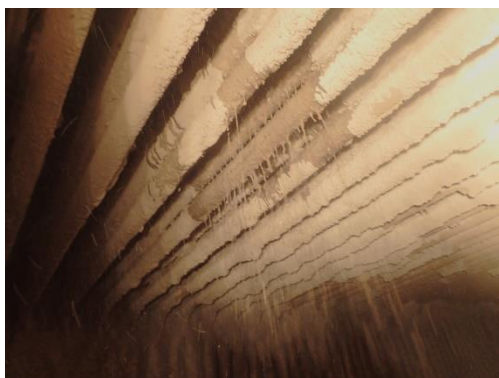
破損したボイラー水管の様子（左、中央は漏水時の様子、右は破損状況）
